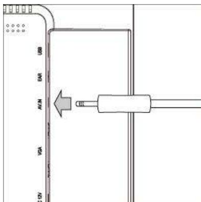
ビデオ接続を行う場合は、付属のビデオケーブル【3.5φミニピン～赤・白・黄 RCA】ケーブルを使用します。本ケーブルの3.5φミニピンコネクタを矢印の方向へ接続してください。
