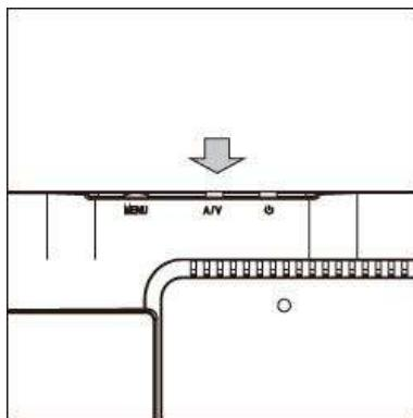
「F キー設定」にて選択した機能をファンクションキー機能で有効、無効、または、数値の変更を行うには本体 A/V(入力切替)ボタンを長押しします。左図矢印のボタンを長押ししてください。
