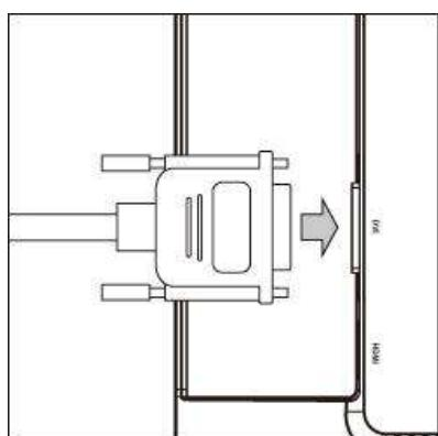
DVI 接続を行う場合は、別途 DVI ケーブルをご用意いただき矢印の方向へ接続し DVI ケーブルコネクタ取り付けネジを締めて接続を固定してください。
