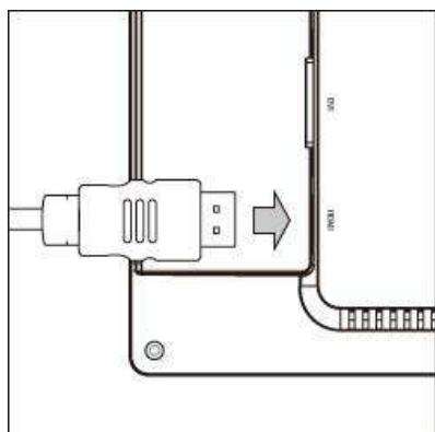
付属の HDMI ケーブルを矢印の方向へ接続してください。
