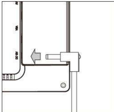
付属の AC アダプター DC コネクタを矢印の方向へ接続してください。
