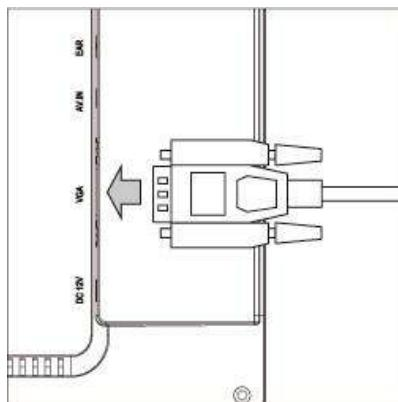
付属の VGA ケーブルを矢印の方向へ接続し VGA ケーブルコネクタ取り付けネジを締め接続を固定してください。
