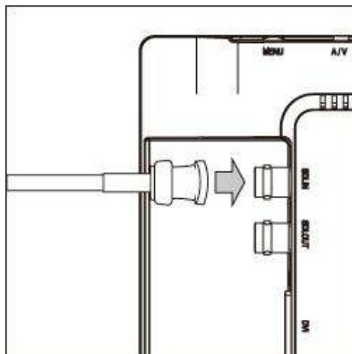
SDI 接続を行う場合は、別途 BNC(同軸)ケーブルをご用意いただき矢印の方向へ接続し BNC ケーブルコネクタを回し接続を固定してください。
